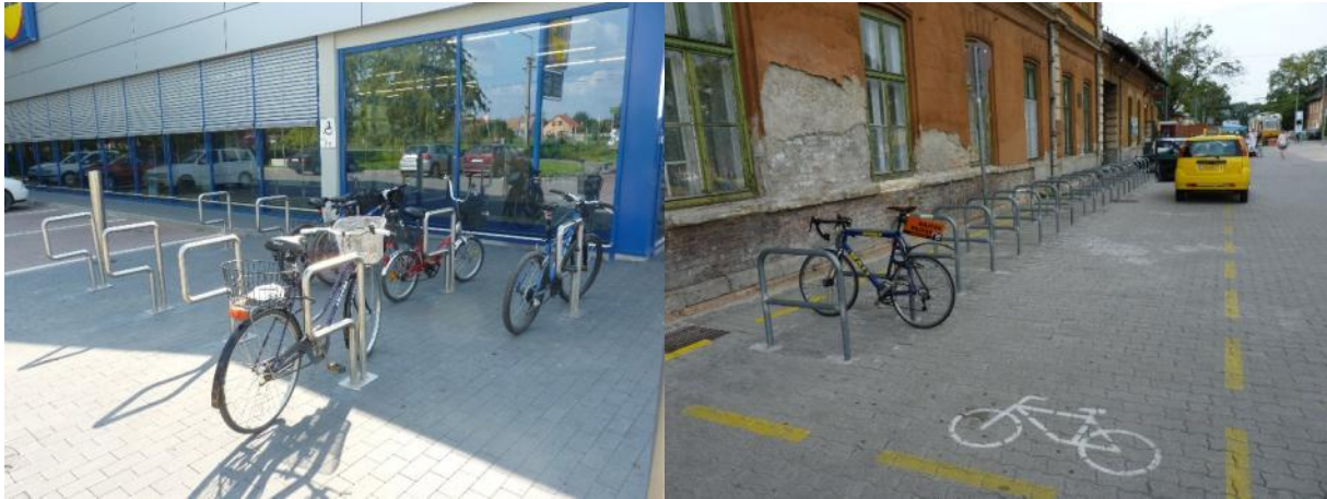
18. ábra: Kerékpárok biztonságos rögzítésére, a váz megtámasztására és lakatolására alkalmas kerékpártámaszok (Dombóvár, Lidl / Budapest, Kelenföldi pályaudvar)
