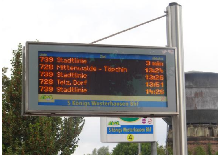
15. ábra: Egyszerű vizuális utastájékoztató panel helyi és regionális autóbuszok indulási időpontjának feltüntetésére (Königs Wusterhausen, Németország)
